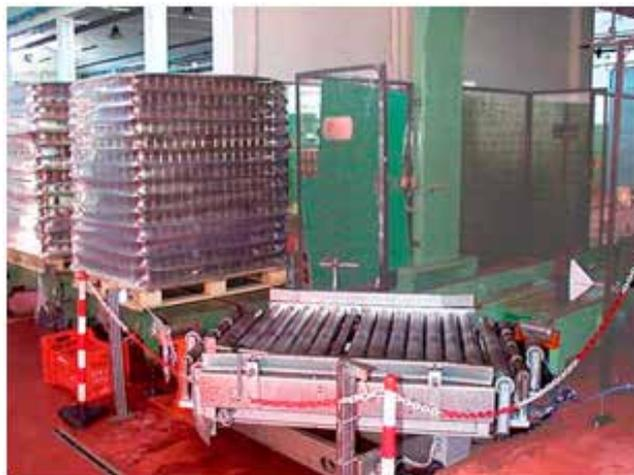
**Figura 5.** Maquinaria para paletización.
